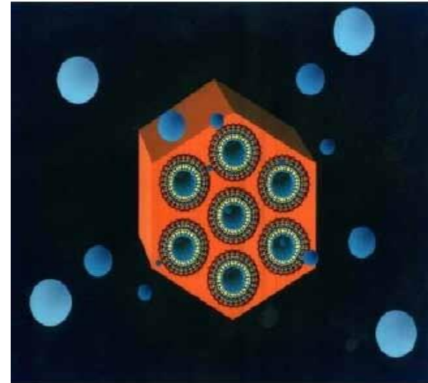
“Filtro molecolare” con substrato di silice con nanopori (6,5 nm) che legano e catturano il mercurio
